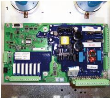
1 Tarjeta de control electrónico | 2 Capacitores | 3 Indicador de estado del interruptor
