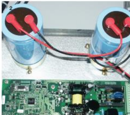
1 Tarjeta de control electrónico | 2 Capacitores | 3 Indicador de estado del interruptor
